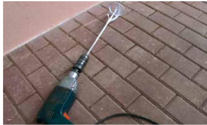
Рис. 3 – Такой инструмент должен быть использован только для смешивания небольшого количества жидких продуктов.
