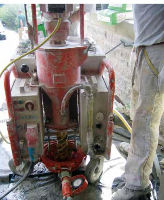
Рис. 16 – Закрытая система – Смесительный насос PFT G4 со встроенным смесителем.
