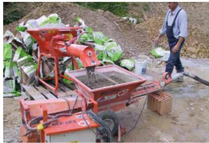
Рис. 19 – Открытая система PFT – смеситель и насос непрерывного действия.
