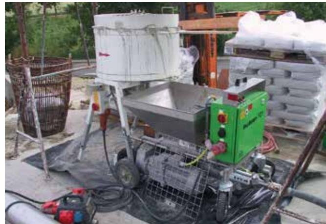
Рис. 20 – Открытая система InoTec – порционный смеситель и насос.
